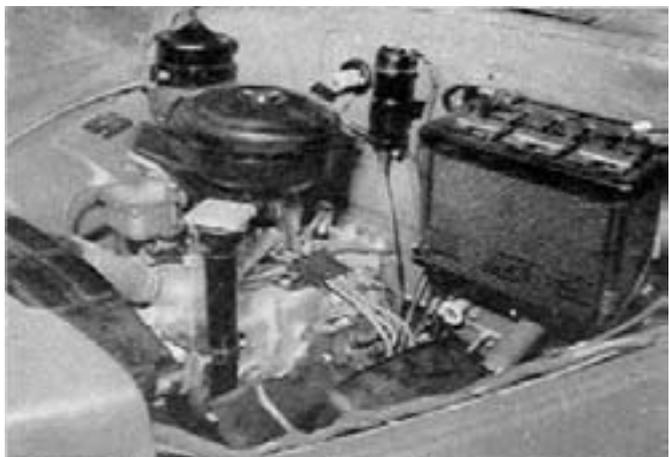
ЧЕТЫРЕХЦИЛИНДРОВЫЙ ДВИГАТЕЛЬ имеет 13-ти вольтовую батарею и с пол-оборота запускается на американском бензине. Снабжен отдельной лампой
